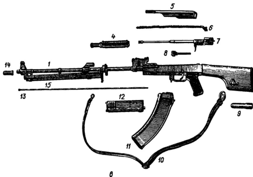
**Рис. 4. Основные части и механизмы автомата (пулемета) и его принадлежности:**
