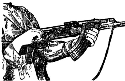
**Рис. 74.** Автомат, приготовленный для проверки разряжания
