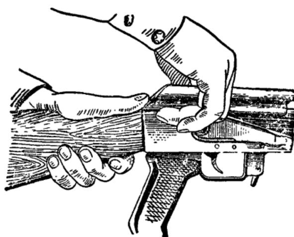
Рис. 5. Отделение крышки ствольной коробки
