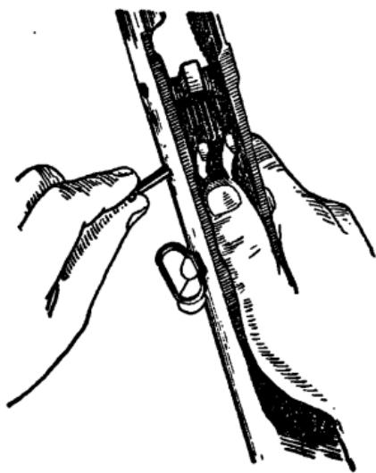
Рис. 18. Вынимание оси спускового крючка и отделение шептало одиночного огня
