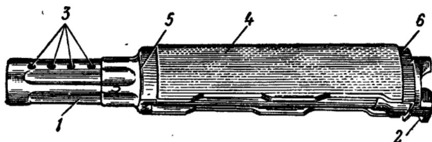
Рис. 36. Газовая трубка со ствольной накладкой:
