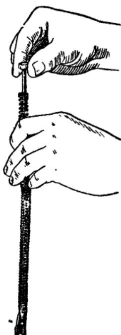
Рис. 12. Разборка возвратного механизма
