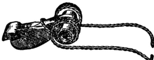
Рис. 22. Положение боевой пружины на курке
