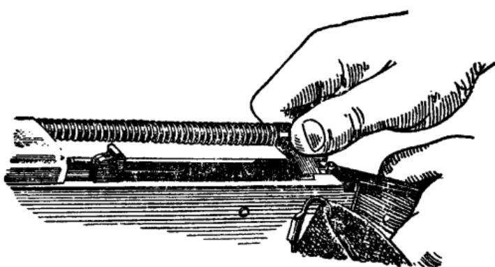
Рис. 6. Вынимание возвратного механизма
