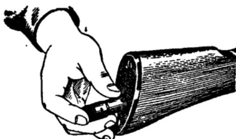
Рис. 10. Вкладывание пенала в гнездо приклада
