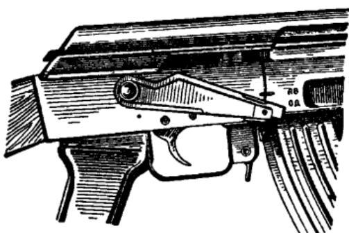
**Рис. 60.** Переводчик установлен для ведения одиночного огня
