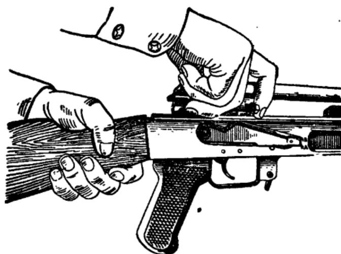
Рис. 7. Отделение затворной рамы с затвором
