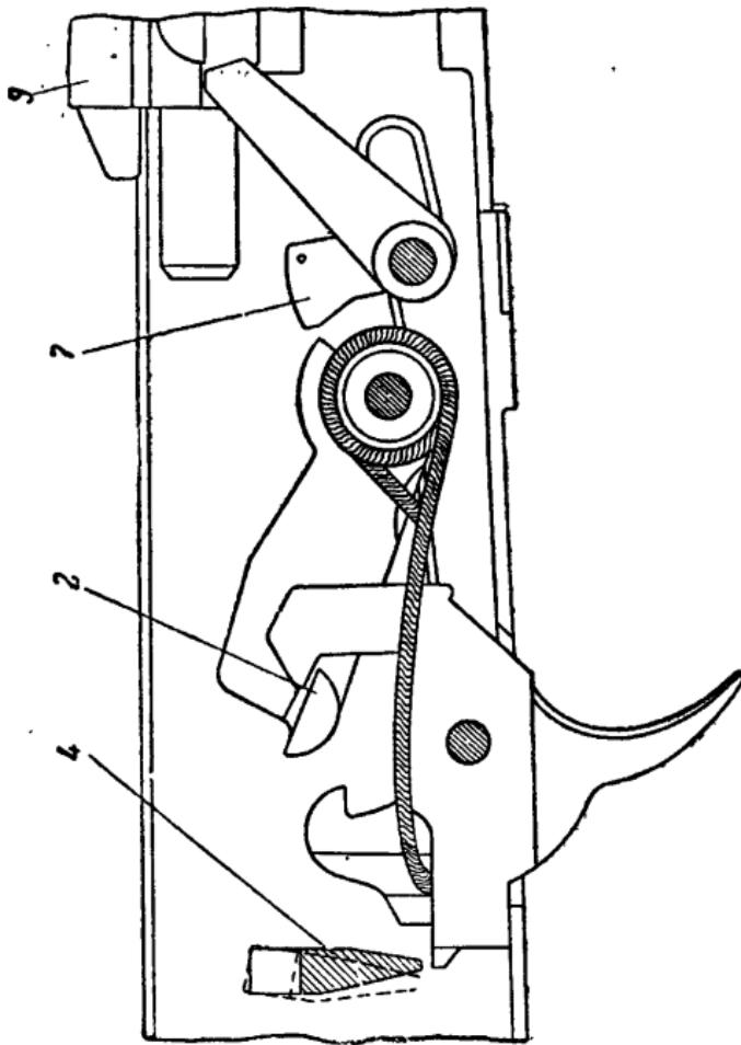
Рис. 45. Положение частей ударно-спускового механизма перед выстрелом:
