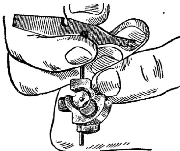
**Рис. 14.** Выталкивание шпильки при разборке затвора
