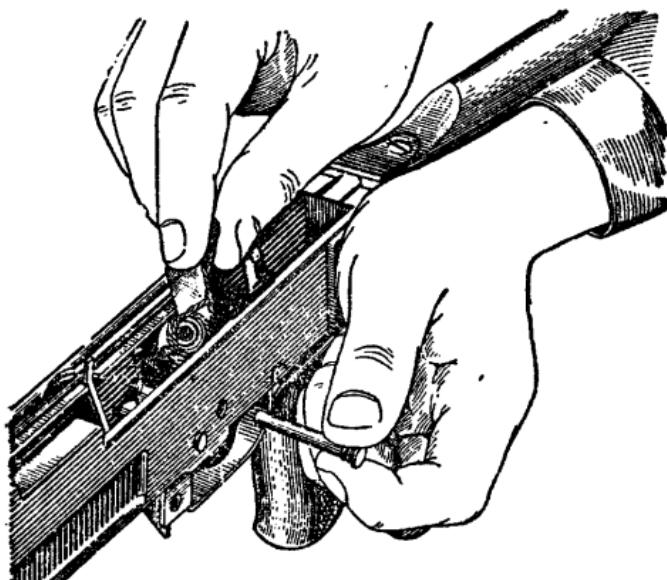
Рис. 17. Вынимание курка из ствольной коробки
