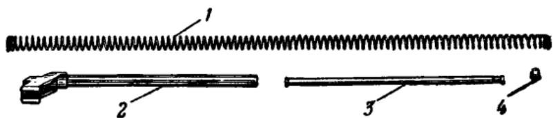
Рис. 35. Возвратный механизм:
