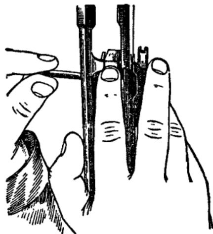
Рис. 21. Вставление оси автоспуска
