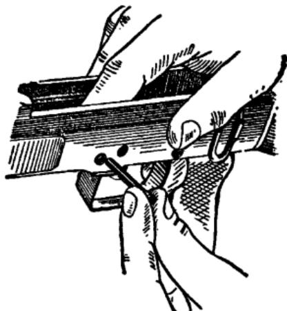
Рис. 19. Вынимание оси автоспуска
