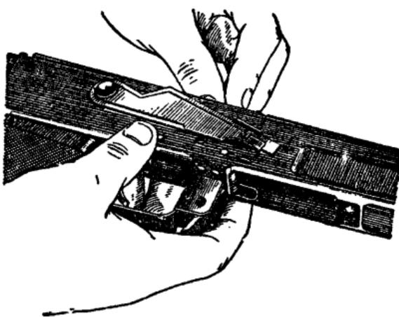
Рис. 23. Удержание автомата при досылке оси курка
