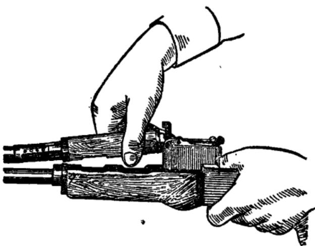
Рис. 9. Отделение газовой трубы со ствольной накладкой
