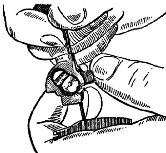
**Рис. 24.** Ввод шпильки в отверстие затвора
